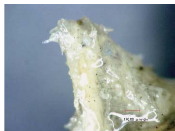
固化処理後のアスベスト針状結晶
