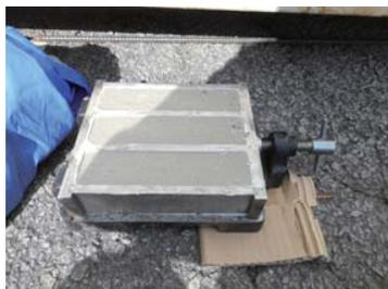
SKY-G1/SKY-CSP60%(W/C)のペースト供試体採取時。通常セメントでは採取直後にはブリーチングが上がりセメントペーストは沈降する。
