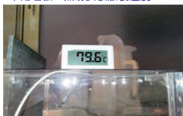
未処理板：照射試験版裏温度
