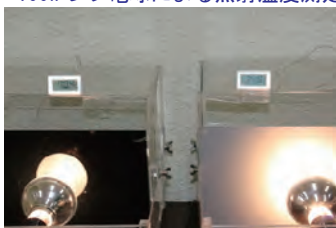
100W レフ電球による照射温度測定
